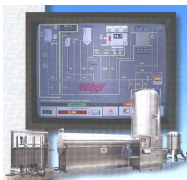
Figure 2. Installation de stabilisation tartrique continue avec d'opération du processus sur l'ordinateur
