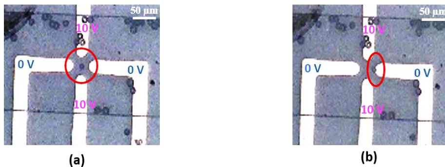
Fig.4. a) cellule piégée en DEP négative; b) cellule piégée en DEP positive.
