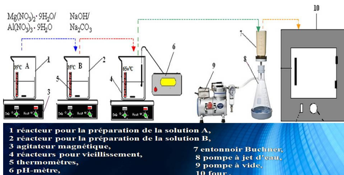
Fig.1. Ensemble expérimental pour la préparation des HDLs
